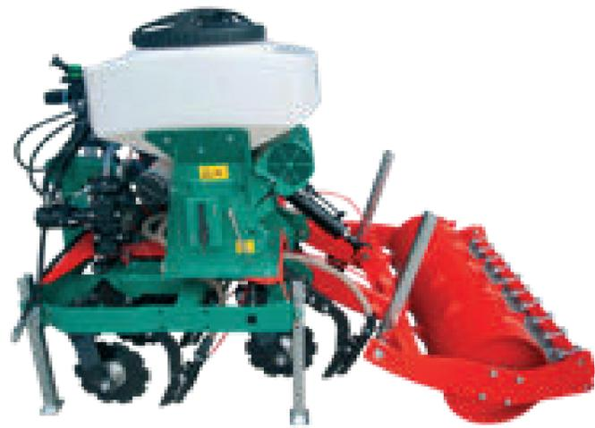
Per prima cosa si smuove il terreno per mezzo di dischi e denti. Si introducono dunque nel terreno in un singolo ciclo di lavoro le sementi e il fertilizzante liquido. È inoltre possibile suddividere le sementi in modo mirato nella zona del ceppo utilizzando uno spargitore laterale. Con oltre 20 combinazioni diverse, la struttura modulare offre una soluzione ideale per il proprio vigneto e frutteto.
