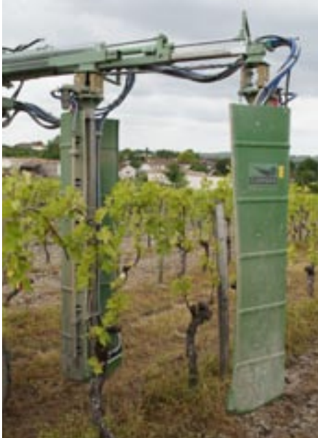
Les deux panneaux récupérateurs avec les turbines tangentielles.
