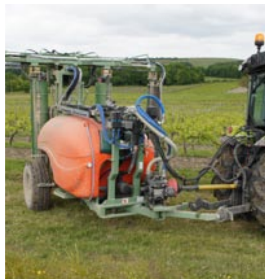
Le timon orientable permet de recentrer l'appareil dans le rang.
