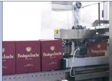
Unità di nastratura per chiusura delle falde superiori ed inferiori Taping unit for upper and lower flaps sealing Verschließen von Boden und Deckel der Kartons mit Klebeband
