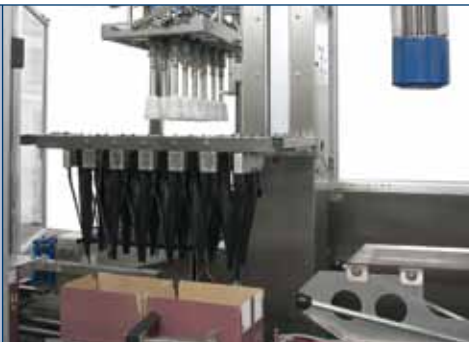
Imbuti centratori per cartoni con alveari preinseriti Centering funnels for cases with preglued partitions Flaschenzentrierung für Kartons mit eingearbeiteten Gefachen
