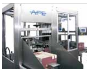
Magazzino cartoni con capacità fino a 75 pz. Cases store with a capacity up to 75 pieces Kartonmagazin, Fassungsvermögen max. 75 Stück
